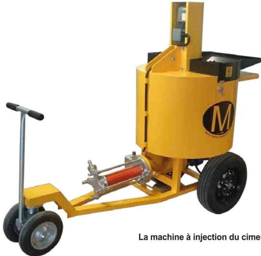
**La machine à injection du ciment par moulage.**
