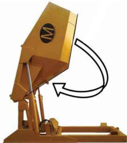
Système qui permet à l'appareil de s'élever plus haut et ainsi de se vider entièrement et plus rapidement
